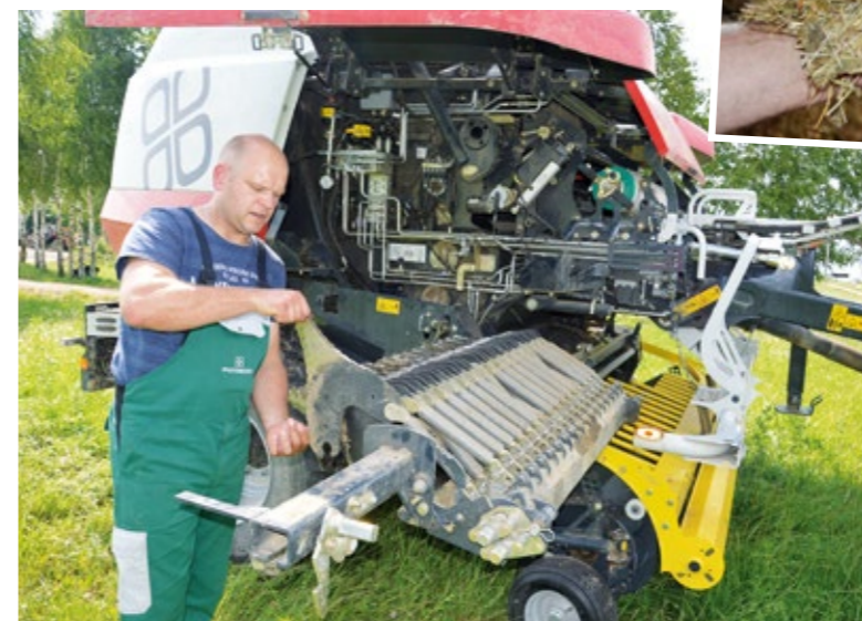
Belka nożowa jest wysuwana, dzięki czemu jej obsługa nie następuje żadnych trudności. Liczbę pracujących noży można w zasadzie konfigurować w dowolny sposób. Przy pracujących wszystkich 32 nożach sianokiszonka jest pocięta na naprawdę małe kawałki.
