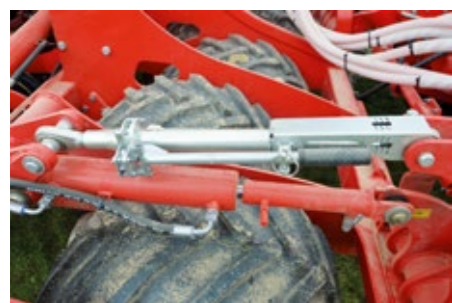
Wał dogniatający składa się z szerokich kół umieszczonych w systemie offset. Za sprawą takiej konstrukcji wał zapada się w glebę podczas pracy. Służy także jako podwozie transportowe, a dzięki unoszeniu środkowej pary kół podczas transportu może przemieszczać się w pełni załadowany.
