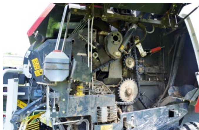
Prasa jest wyposażona w centralny układ smarowania łańcuchów oraz w centralny system smarowania. Podczas codziennej obsługi wystarczy, że operator będzie wtykał smar do jednej kalamitki, a dzięki rozdzielaczowi i wężykom dostanie się on do każdego punktu wymagającego smarowania w maszynie.
