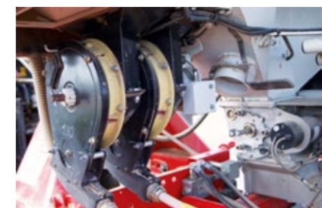
Punktowa aplikacja nasion kukurydzy w siewniku AEROSEM 3002 ADD jest wykonywana za pomocą systemu PCS (PRECISION COMBI SEEDING).
