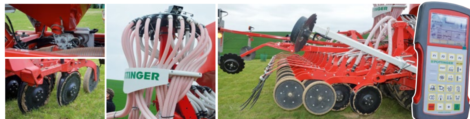
W siewniku TERRASEM za kontrolę wysiewu odpowiada sterownik POWER CONTROL. Przy pomocy sterownika, dobierając odpowiedni walek wysiewający, przeprowadza się próbę kręconą. Sterownik zarządza także pracą głowicy rozdzielającej, która zmniejsza ilość wysiewanych nasion podczas pracy na ścieżce technologicznej. Nasiona w każdych warunkach glebowych z najwyższą precyzją umieszcza w glebie podwójna redlica talerzowa DUAL DISC.
