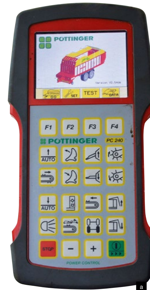
Terminal POWER CONTROL (a) umożliwia nie tylko obsługę funkcji załadunku i rozładunku, lecz także skalibrowanie systemów automatyki, zmianę niektórych parametrów pracy oraz diagnostykę czujników. Menu ustawień wywołujemy poprzez naciśnięcie przycisku F2 (b). Bardzo ważną czynnością jest kalibracja podłogi rusztowej. Wykonujemy ją w menu [SET 4], ustawiając minimalną (c) prędkość przesuwu taśmy oraz prędkość na przedostatnim przełożeniu (d).
