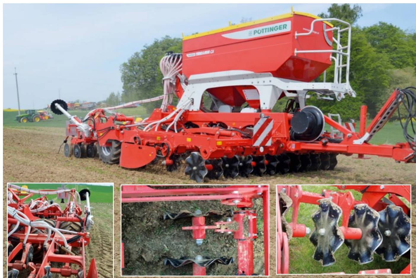
Nowa sekcja doprawiająca składa się z dwóch rzędów talerzy falistych ustawionych pod kątem prostym do podłoża. Każdy talerz doprawiający naciną glebę na szerokość około 5 cm, w tej samej linii pracuje redlica siewna. Maszyny są dostępne z rozstawem rzędów 12,5 lub 16,7 cm. Głębokość pracy talerzy znajdujących się za kołami ciągnika można regulować dodatkowo za pomocą przetyczek.
